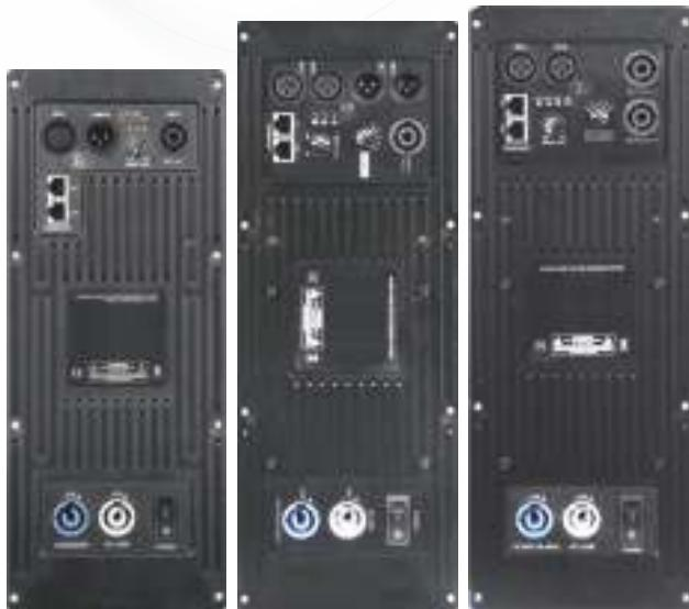
SA有源功放模块，主要用于有源系统，采用Class D类功放电路，模块化设计，独立PWM固频调制，以减小自激电路的差频、合频多通道干扰。两通道内置24BIT/96KHz采样频率的高性DSP处理器,RS485联机或组网调节，输入端31段PEQ，输出端10段PEQ，输入输出延时0~25ms可调，且带独立的带通滤波器，全通滤波器，独立压限，噪声门控制。产品具有功率大、失真低的特点，全屏蔽密封盒，使得产品满足电磁兼容及产品安全等级要求。
