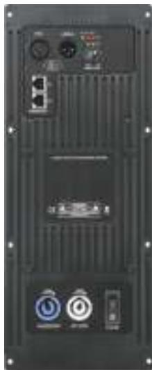
FA有源功放模块，主要用于有源全频音箱，采用Class D类功放电路，模块化设计，独立PWM固频调制，以减小自激电路的差频、合频多通道干扰。两通道内置24BIT/96KHz采样频率的高性DSP处理器,RS485联机或组网调节，输入端31段PEQ，输出端10段PEQ，输入输出延时0~25ms可调，且带独立的带通滤波器，全通滤波器，独立压限，噪声门控制。产品具有功率大、失真低的特点，全屏蔽密封盒，使得产品满足电磁兼容及产品安全等级要求。
