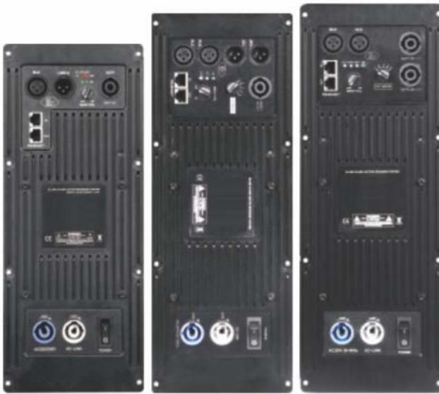
SA有源功放模块，主要用于有源系统，采用Class D类功放电路，模块化设计，独立PWM固频调制，以减小自激电路的差频、合频多通道干扰。两通道内置24BIT/96K采样频率的高性DSP处理器,RS485联机或组网调节，输入端31段PEQ，输出端10段PEQ，输入输出延时0-25ms可调，且带独立的带通滤波器，全通滤波器，独立压限，噪声门控制。产品具有功率大、失真低的特点，全屏蔽密封盒，使得产品满足电磁兼容及产品安全等级要求。
