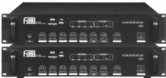
CA系列是合并式定压功率放大器，自带USB和SD卡，开机自动播放MP3曲目，自带FM收音，两路MIC输入，一路AUX线路输入，总音量旋钮控制，MIC输入优于所有输入，有完善的过热保护，使用简单，维护方便；在使用过程中，如果出现短路或过载时，保护电路启动，机器无输出，排除故障后，关闭电源10秒后重新开机，便可正常工作。
